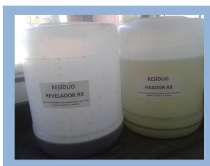
Figura 6 - Recipientes utilizados para descarte de efluentes radiológicos.
