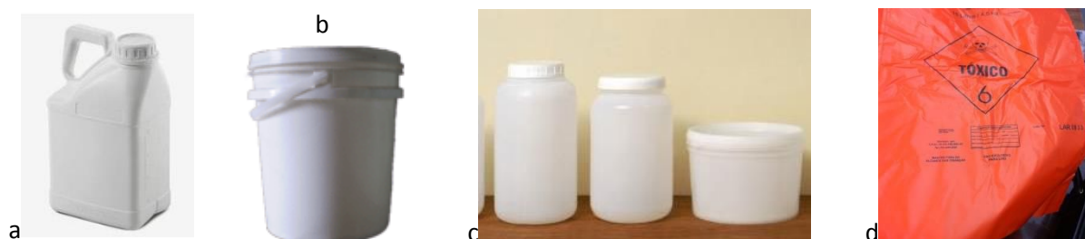
Figura 3 - Embalagens Internas para Resíduos Sólidos: (a, b) bombonas e baldes de PEAD na cor branca, com alça e tampa estreita ou larga, rosqueada e capacidades 5L, 10L e 20L; (c) potes de PEAD na cor branca, com tampa larga rosqueada e capacidades 100ml, 250ml, 500ml, 1L, 2L, 3L; (d) sacos plásticos de polietileno de alta densidade, cor laranja, com capacidades de 15L, 30L, 50L, 100L.
