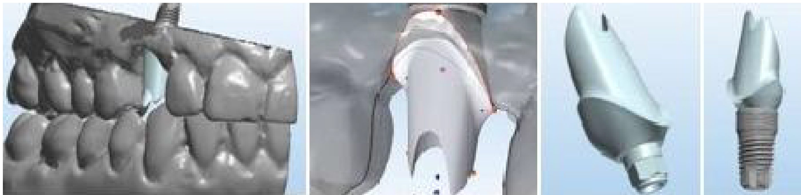
IMAGENS DIGITAIS DO MUNHÃO OBTIDO POR SISTEMA CAD/CAM.
