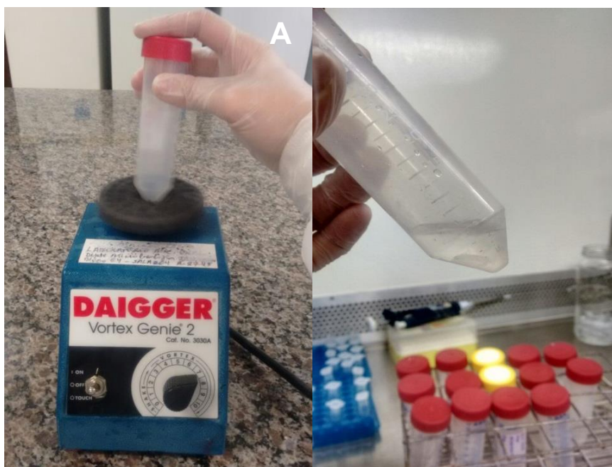
Figura 24 - (A) Desprendimento do biofilme por vortex e (B) tubo falcon contendo o disco de silicone e 4 ml de PBS após agitação
