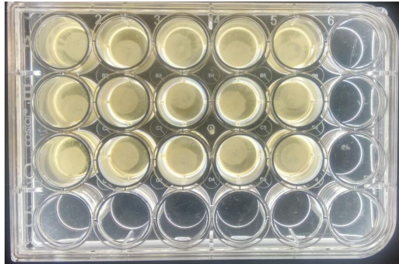
Figura 22 – Discos de silicone imersos no meio de cultura inoculado com S. aureus após 48 horas de desenvolvimento do biofilme
