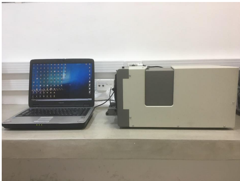
Figura 8 – Espectrofotômetro de luz ultravioleta visível (CM-3700D; Konica Minolta) utilizado para medição dos parâmetros de cor dos espécimes.
