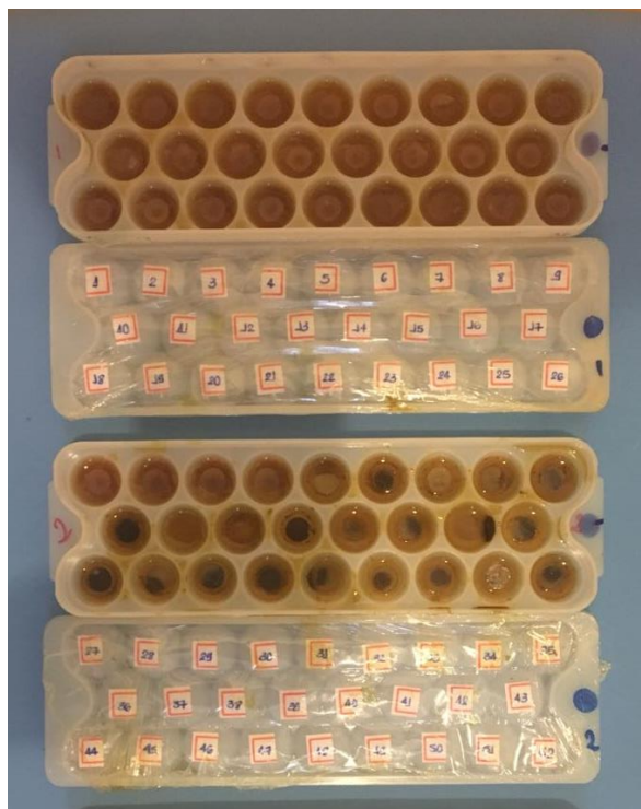
Figura 7 – Procedimento de desinfecção dos espécimes durante 60 dias por imersão nas soluções propostas no estudo.
