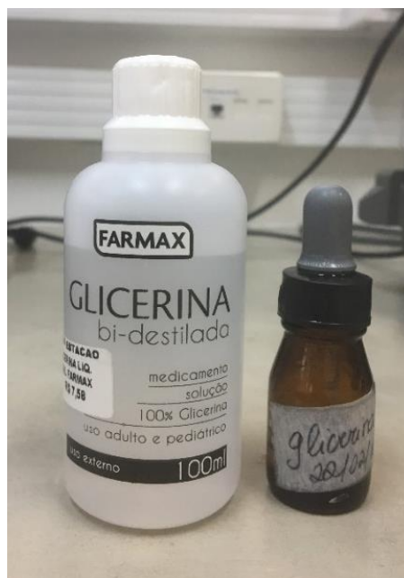
Figura 9 – Acoplante líquido utilizado entre o fundo de leitura do anteparo e o espécime.
