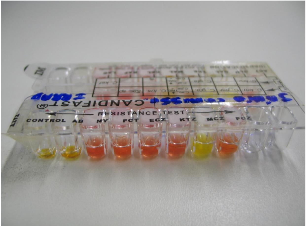
Figura 25: Teste de resistência aos antifúngicos Candifast®: Positivo para anfotericina B e miconazol
