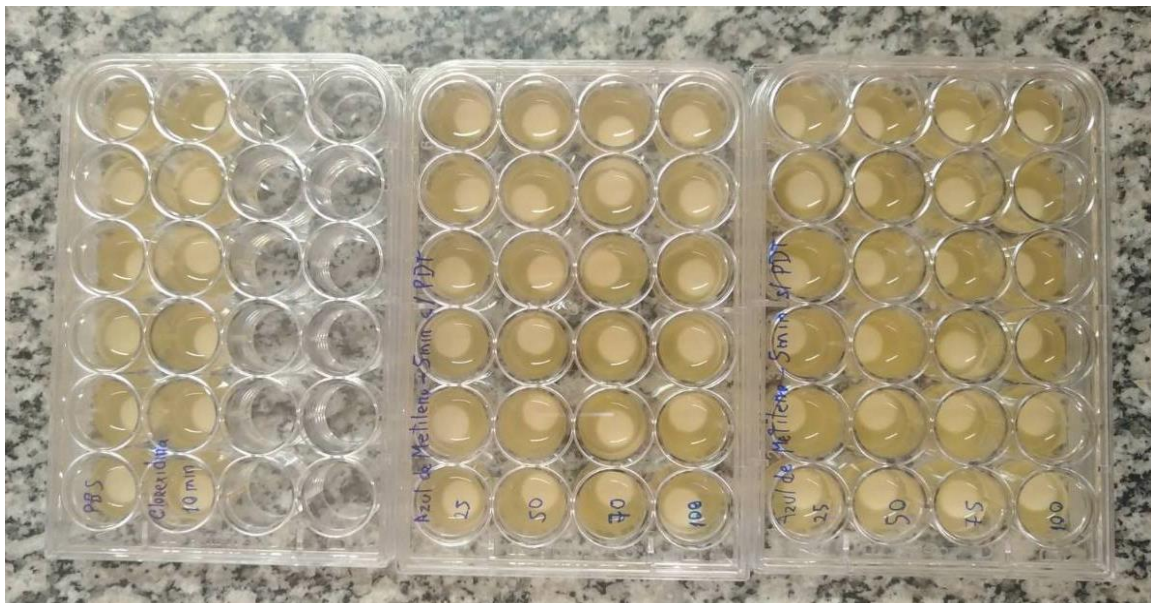
FIGURA 12. Placa de 24 poços com discos de resina imersos em caldo BHI suplementado com 1% de sacarose, com S. aureus , na concentração de 10^8 células/mL (DO 620nm=0,5).
